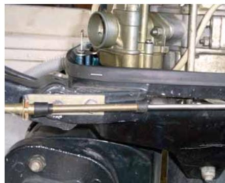
Рис. 4. Подключение к мотору троса "газа"
