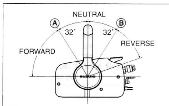
управления и подайте ручку вперед до положения А. Чтобы включить заднюю передачу, сожмите разблокирующий рычаг на ручке управления и потяните ручку на себя до положения В.
