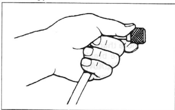
3. Поверните вентиляционную гайку против часовой стрелки, чтобы открыть вентиляцию.
