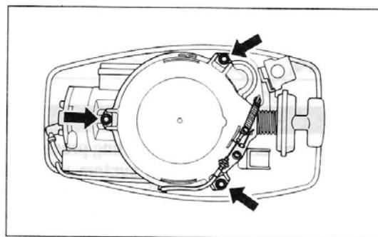
4. Снимите стартерное устройство.
