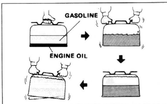
мотор часто используется при максимальных нагрузках, рекомендуется смешивать масло с бензином в пропорции 1:50.
