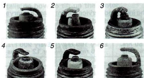
1. Сильный износ 2. Трещина
