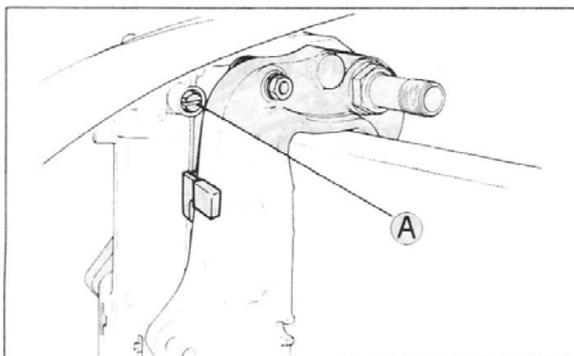
Рулевое управление на Вашей лодке должно быть ровным и не тугим. Настройте жесткость поворота так, чтобы чувствовалось легкое сопротивление. Для увеличения сопротивлений поверните болт А по часовой стрелке, для уменьшения – против часовой.
