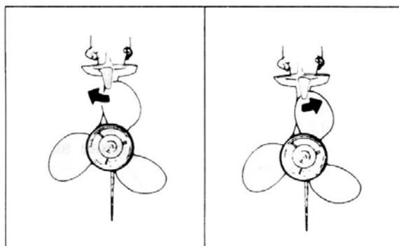
3. Зафиксируйте положение киль-протектора, плотно закрутив болт.
