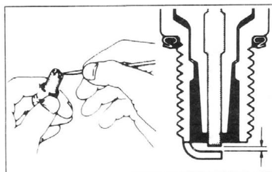
Зазор свечи зажигания
