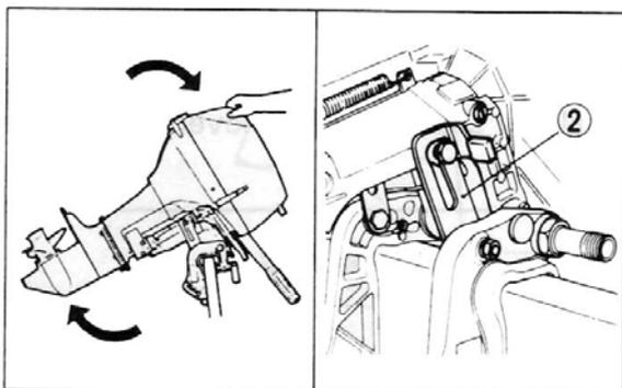
3. Надавите на кнопку 2, чтобы зафиксировать мотор в приподнятом положении. Чтобы опустить мотор обратно, потяните мотор слегка к себе, потяните за эту кнопку и медленно опустите мотор.
