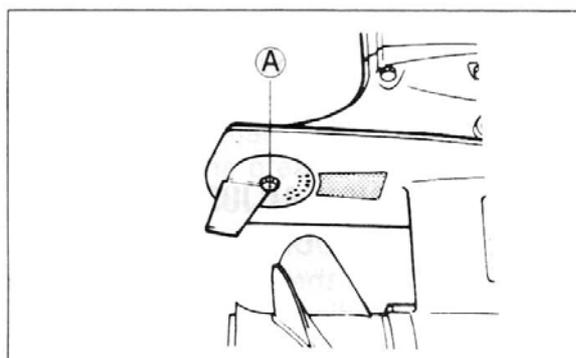
2. Если лодка постоянно уклоняется на левый борт, сместите задний конец киль-протектора по направлению к левому борту. Если лодка уклоняется на право, поверните задний конец киль-протектора к правому борту.
