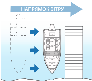
Мал. 19. Швартування коли вітер або течія штовхають човен до причалу.
